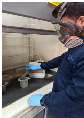
Figura No. 1 acidificación de muestras de roca.
